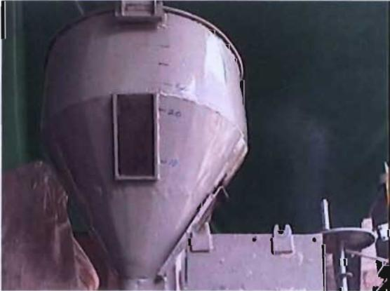
Figure E7: Feedstock hopper
