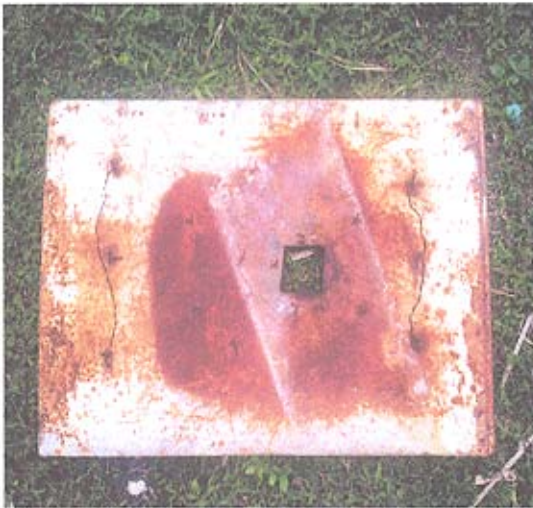
Menghasilkan tudung tanur dan ditebuk lubang untuk memudahkan angin keluar
