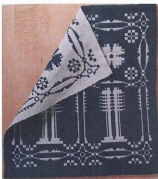
Gambarajah 2.1: Fabrik double weave menggunakan teknik pick-up
